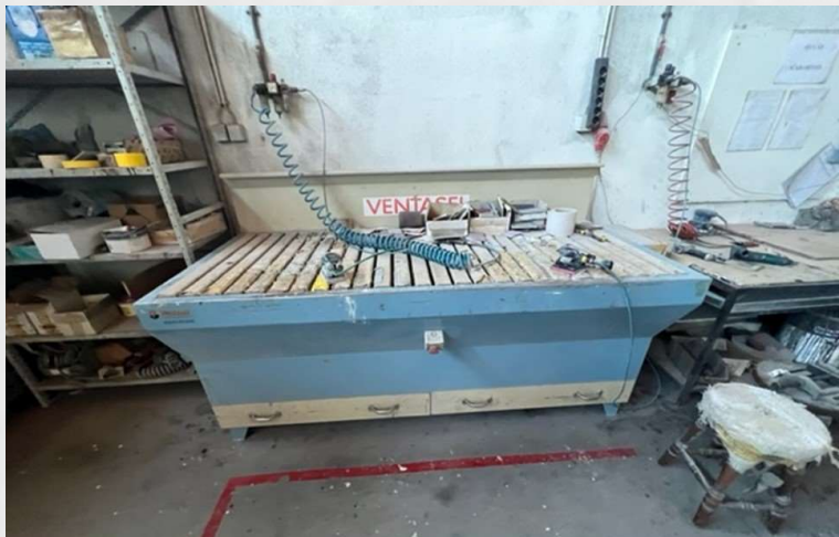
VERBA 12: Mesa de lixar com aspiração com duas lixadeiras pneumáticas.
